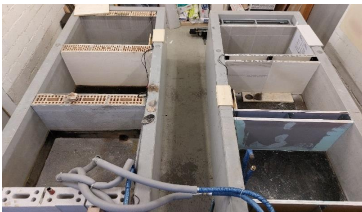
Abb. 1: Die Testbecken mit verschiedenen Bodenaufbauten sowie Wandkonstruktionen in Massiv- und Leichtbauweise.
