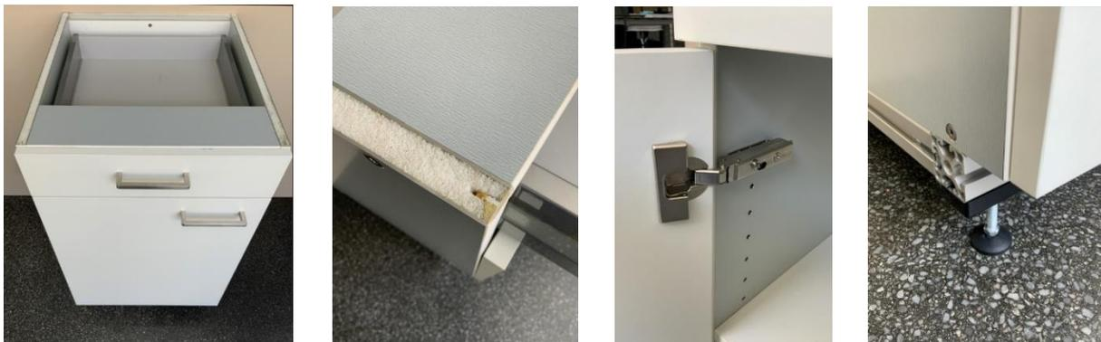
Die NSV-Küche besteht aus Sandwichplatten (CoraPET) mit einer 1mm Aluminiumbeplankung und einem wasserresistenten PET-Schaumkern. Der Sockel ist mit ITEM-Aluprofilen ausgeführt und gewährleistet, dass keine Wasserschäden entstehen können.
